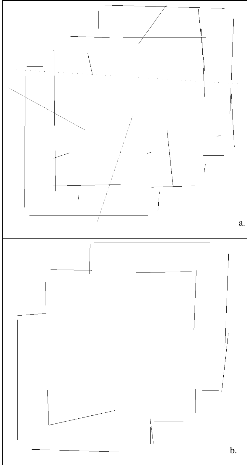
Şekil 7.5 Ortam 1'de, standart sapması 4 cm olan algılayıcı gürültüsü varken duvar takibi ile çıkarılan haritalar.
